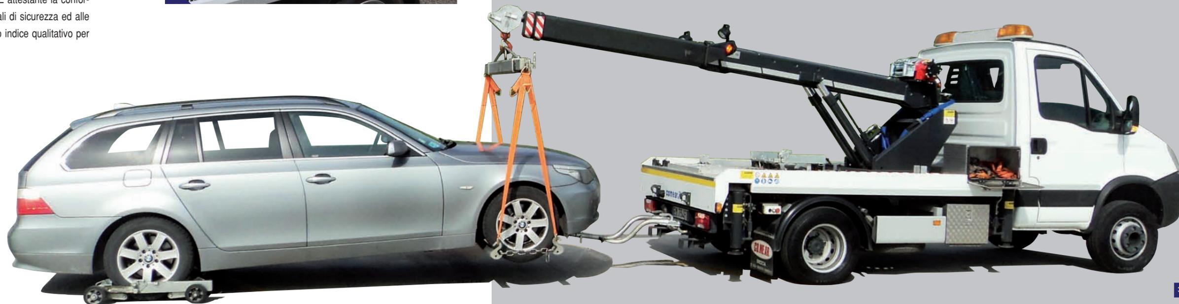
1 Il **bilancino** consente di sollevare la vettura in sosta, di posizionarla sulla strada e di trainarla con asse sollevato. Il **verricello idraulico** posizionato sul braccio consente, previo il posizionamento dei 4 piedi stabilizzatori, di utilizzare il braccio stesso come gru per il recupero di autovetture incidentate.
